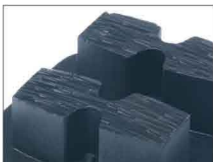
Debido a la forma de los segmentos Husqvarna los diamantes son más activos con un amolado más agresivo que los de forma rectangular tradicional. Los segmentos preafilados permiten a la herramienta de diamante trabajar con una eficacia del 100% desde el inicio sin necesidad de preparar la herramienta.
