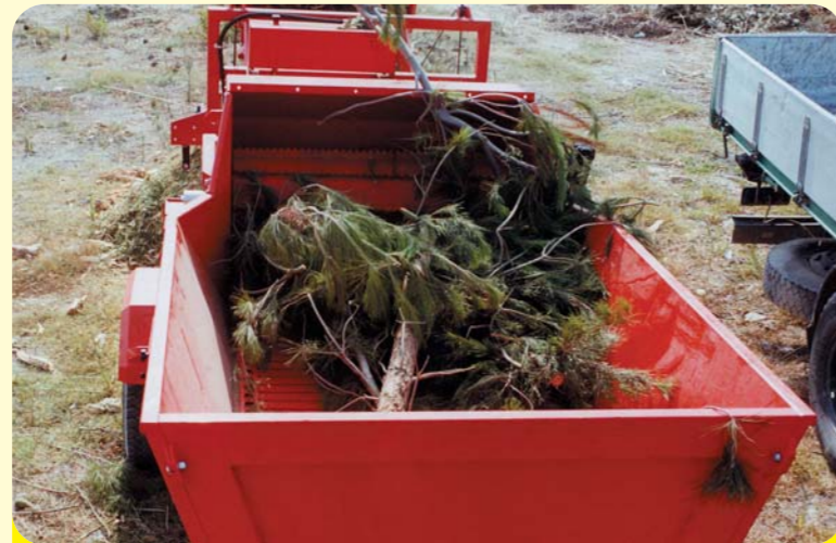
TRAMOGGIA DI CARICO
