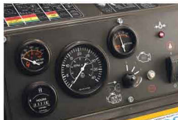
El tacómetro indica el régimen de revoluciones del motor/ eje del disco. El campo de revoluciones del eje del disco está codificado en colores para seleccionar la posición de la caja de cambios.
