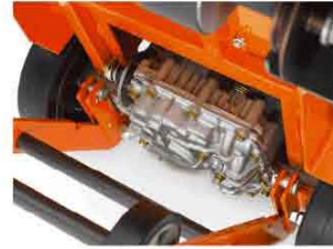
Sistema propulsor diferencial autocontenido que elimina los engranajes de marcha de las ruedas traseras y asociadas. Fácil de operar y mantener.
