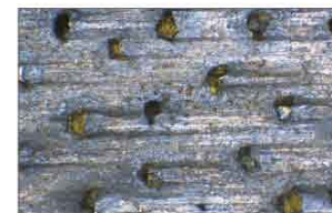
Diagrip™ es la nueva tecnología de producción de segmentos con un tratamiento especial que garantiza una distribución óptima de los diamantes, que produce discos con mejor vida útil y capacidad de corte.
