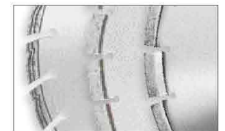
Gracias a la forma del segmento el inicio del corte es suave y limpio.
