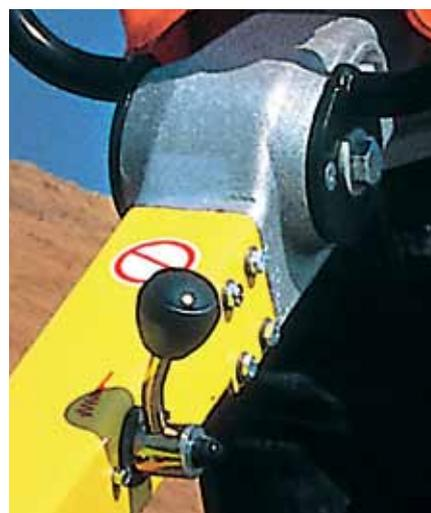
Control del acelerador en el brazo de guiado
