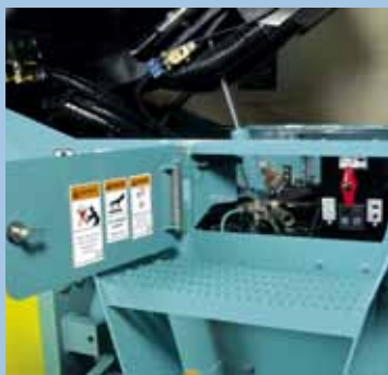
Cabina abatible para fácil y seguro mantenimiento y control
