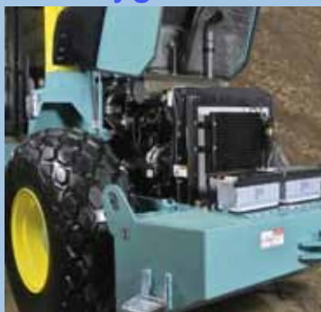
Zona del motor y baterías fácilmente accesible
