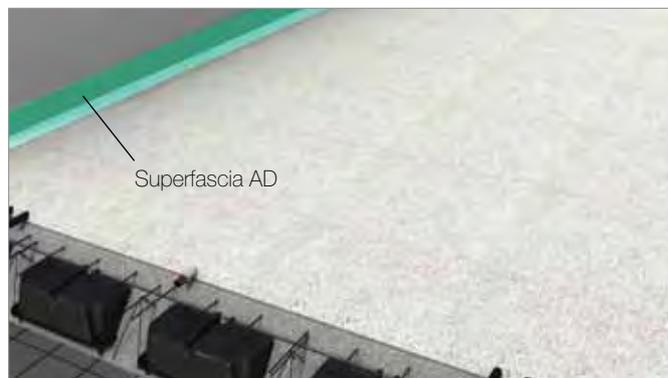
**2** Fijar la banda perimetral a la pared a una altura equivalente "por lo menos" a la de la alcatifa más la de la pavimentación final, solapando el orillo horizontalmente a fin de crear una "ele" entre la pared y la superficie horizontal. Asegurarse de que el material garantice una completa desolidarización entre la alcatifa de cemento y los elementos estructurales de la obra en correspondencia de todos los umbrales y de los ángulos.
