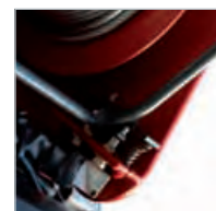
Final carrera superior e inferior / Top and bottom limit switch
