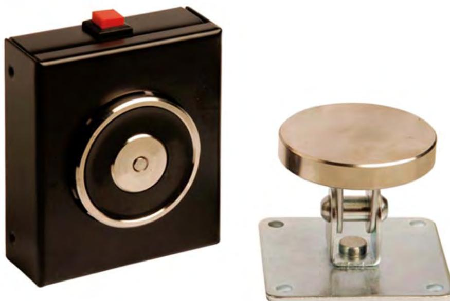
La contra placa consta de un cuerpo de acero Redondo con un anclaje Redondo de caucho para la unión articulada a la base del metal cincado con un diámetro de contra placa de 55 mm.
