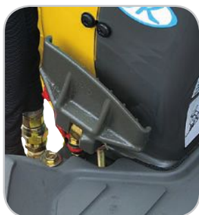
Pedales retráctiles (pedal de toma de fuerza y pedal de orientación de la pluma)
