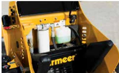
**MANTENIMIENTO FÁCIL.** Abra un panel para acceder al filtro hidráulico, al llenado del radiador y al panel de control eléctrico.
