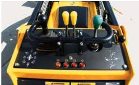
**FACILIDAD DE CONDUCCIÓN.** El desplazamiento se controla con una sola palanca de mando, lo que brinda al operador una amplitud de movimiento suave, mientras que los controles de palanca de doble eje controlan el movimiento del brazo y el cucharón. Las luces de advertencia de presión de aceite del motor, temperatura
