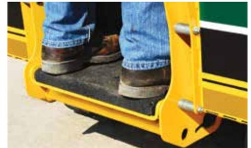
**SOBRE LOS PROBLEMAS.** Una plataforma segura mantiene al operador alejado del lodo. El sistema integrado de presencia del operador suspende el desplazamiento y el movimiento del brazo o cucharón cuando el operador se sale de la plataforma.
