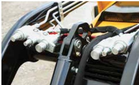
**BAJO FLUJO NECESARIO.** Un circuito auxiliar hidráulico doble opcional agrega una opción de bajo flujo al circuito hidráulico para el uso con accesorios de función doble.
