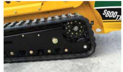
**NO LO DESGASTE.** Un engranaje de oruga de montaje alto elimina el desgaste provocado por el contacto con el suelo.
