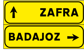
TS-220 Preseñalización de direcciones
