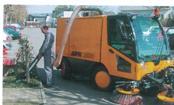
Limpieza de arriates, y vaciado de arquetas y cubos de basura con la manguera de aspiración.
