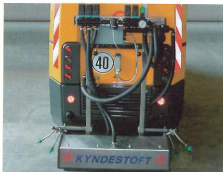
Combate las placas de hielo con solución salina con dosificación dependiente del camino. Anchura de trabajo de hasta 300 cm, volumen del depósito de hasta 2250 l.
