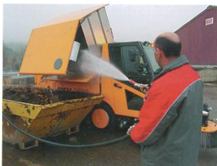
Vaciado en contenedores de hasta 135 cm de altura y aplicación de chorro de agua con la propia bomba de agua con hasta 200 bares.
