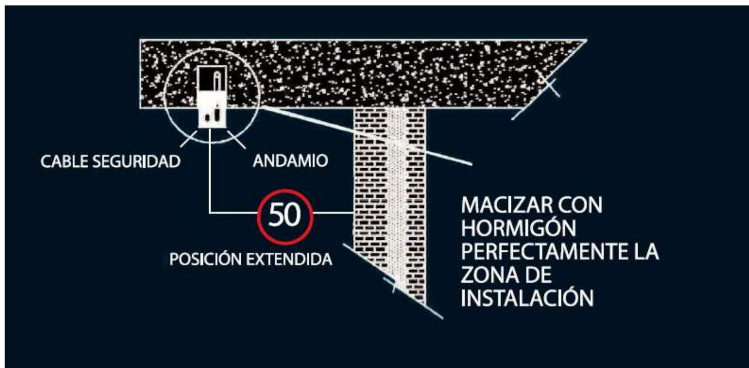
1. Este equipo de trabajo sirve de estructura de suspensión para la instalación de plataformas suspendidas de nivel variable (SAE) tipo TSP (andamio colgante) en los edificios.
