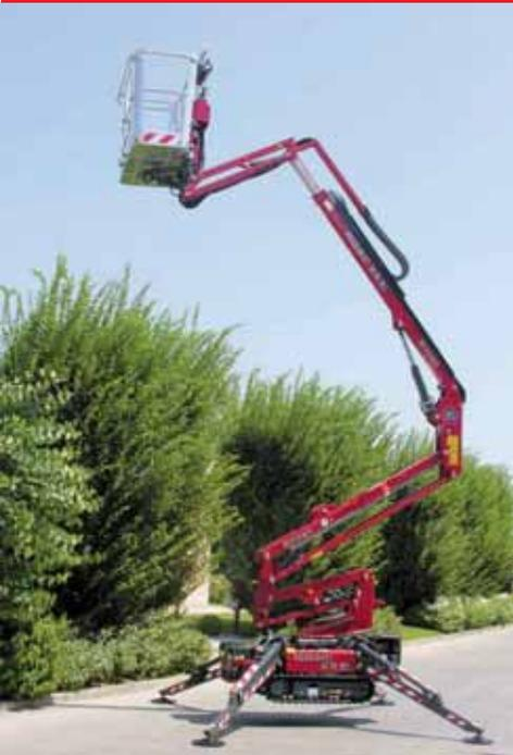
Entre las características de serie, hay la **posibilidad de accionar la máquina a distancia con un radiomando** que controla todas las funciones principales como: selección de los motores, autoestabilización, autodesestabilización, display interactivo.
