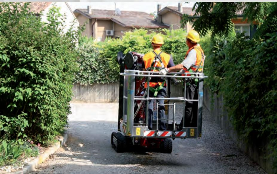
El innovativo sistema de tracción Auto2Speed permite alcanzar la velocidad óptima de translación de 3,6 Km/h para desplazarse rápidamente de un lugar a otro. Además gracias al control sobre la inclinación la máquina desacelera automáticamente en condiciones extremas, beneficiando la seguridad del operador.
