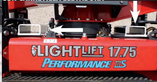
Para transportar la máquina Lightlift 17.75 PERFORMANCE se puede utilizar una carretilla elevadora. Este sistema es muy útil para desplazar la máquina en la obra y para cargar y descargar.
