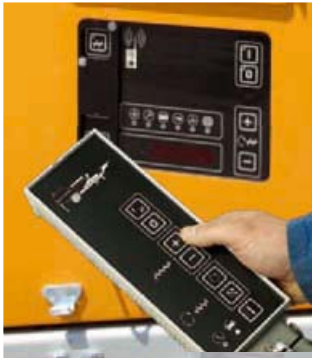
Puede manejar la SP 20 completamente desde un lateral o a través de un cómodo telemando por cable.
