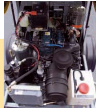
El M 730 dispone de un potente motor diesel de 3 cilindros.
