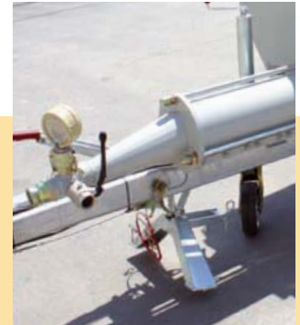
La bomba sinfín del tipo 2L8, de bajo desgaste.
