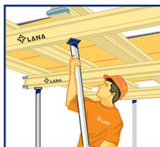
2. Colocar vigas secundarias perpendicularmente a las primarias con distancias según tabla de cargas.
