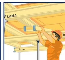
4. Bajar vigas y tableros mediante cabezales basculantes y retirar puntales intermedios.
