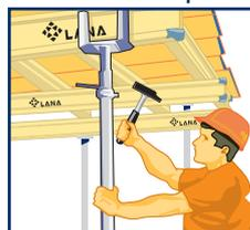
3. Bajar vigas y tableros intermedios y tableros tri-capa apuntalados a las vigas secundarias.
