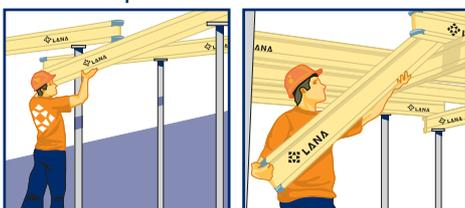
1. Montar puntales y vigas primarias, utilizando tripodes y cabezales "U" en los puntales para mayor seguridad.
