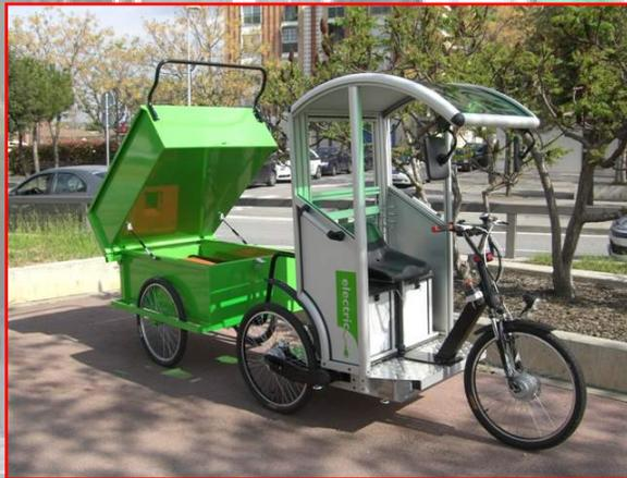
Para ser utilizados conjuntamente con los triciclos hemos diseñado una gama de remolques que se puede configurar de diversas formas y tamaños, según el tipo y número de contenedores o las aplicaciones, herramientas, etc. que tengan que llevar.
