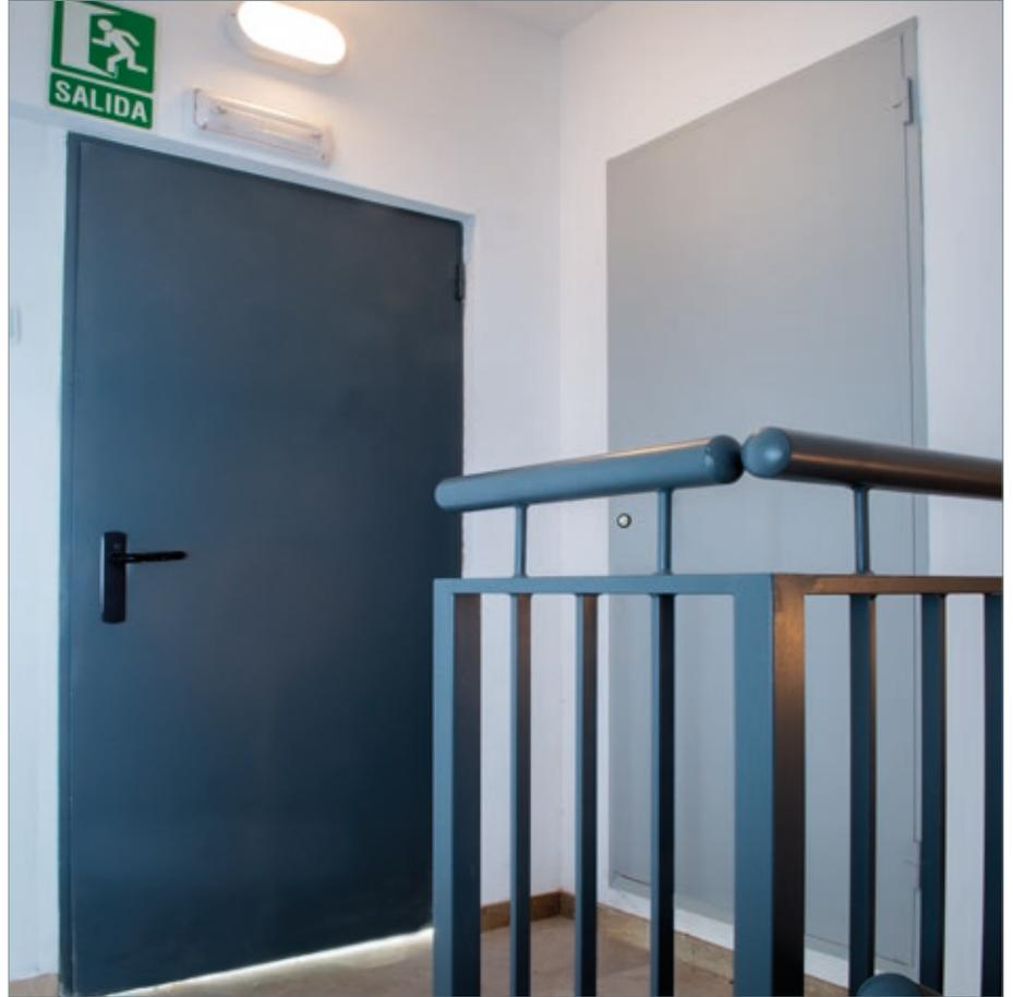
Hoja de 62mm de espesor, construida con dos planchas de acero galvanizado con protección antifinger 0.7mm de espesor, ensamblada sin soldaduras. Cerradura de leva con llave de triángulo, centrada sobre la hoja.
