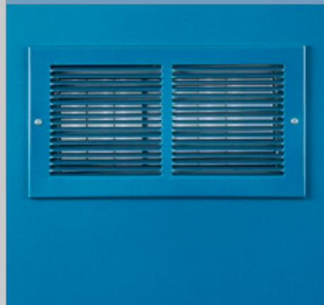
Las rejillas Corta-Fuegos permiten una ventilación a través de las puertas, manteniendo intacta su capacidad de resistencia al fuego. Están compuestas por una serie de laminas horizontales intumescentes con un marco perimetral, que asegura la absoluta estanqueidad en caso de incendios. Clasificación al fuego EI<sub>2</sub> 30, 60 y 90
