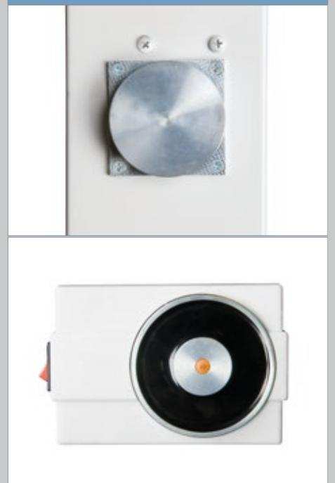
Este mecanismo de seguridad, conectado a la red eléctrica, permite el paso de la corriente a través del mismo, para mantener la puerta abierta. En caso de cese de la corriente libera la hoja, permitiendo su cierre automático.
