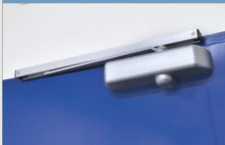
Accesorio instalado en el marco, en la parte superior de la hoja, que controla y asegura el cierre de la misma. Permite un cierre controlado de la hoja, tanto en los modelos de una como de doble hoja. No requiere marcado CE. La elección del mismo debe hacerse en función del tamaño y peso de la puerta.
