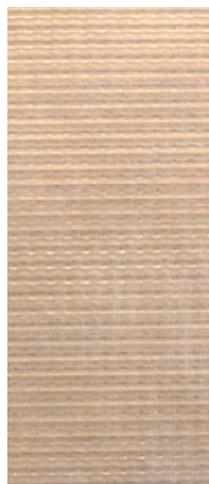
Lámina impermeable y transpirable compuesta de una capa de Tyvek® con aluminizado.
