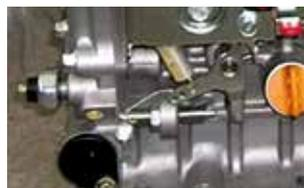
Dispositivo de control de nivel de aceite: sistema de desconexión por falta de aceite
