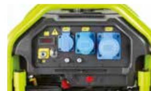
Panel de control equipado con tomas CE y visor digital con 3 funciones disponibles (cuenta-horas, voltímetro y frecuencímetro)
