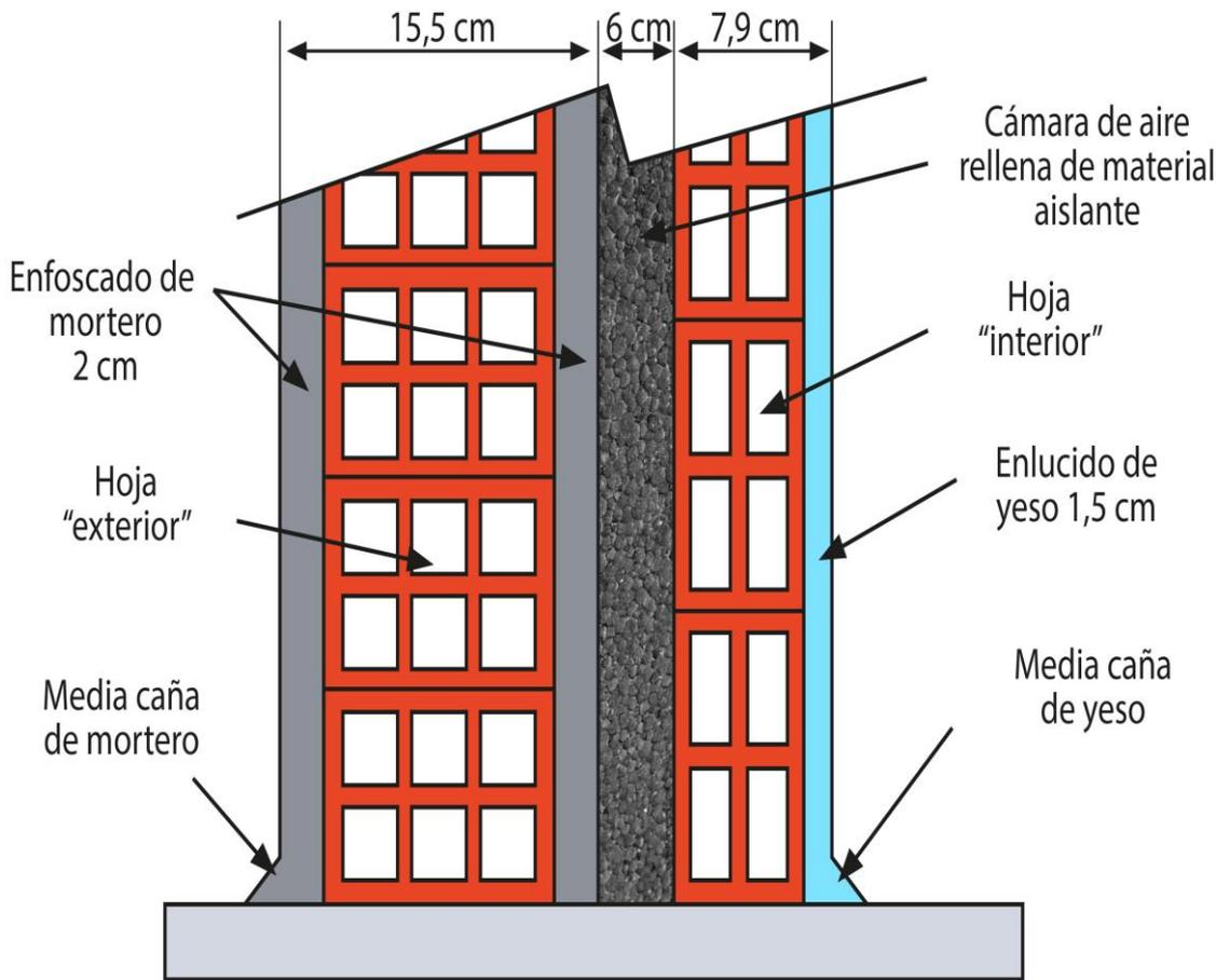
Índice de aislamiento Ruido aéreo  $R_a \geq 54$  dBA
